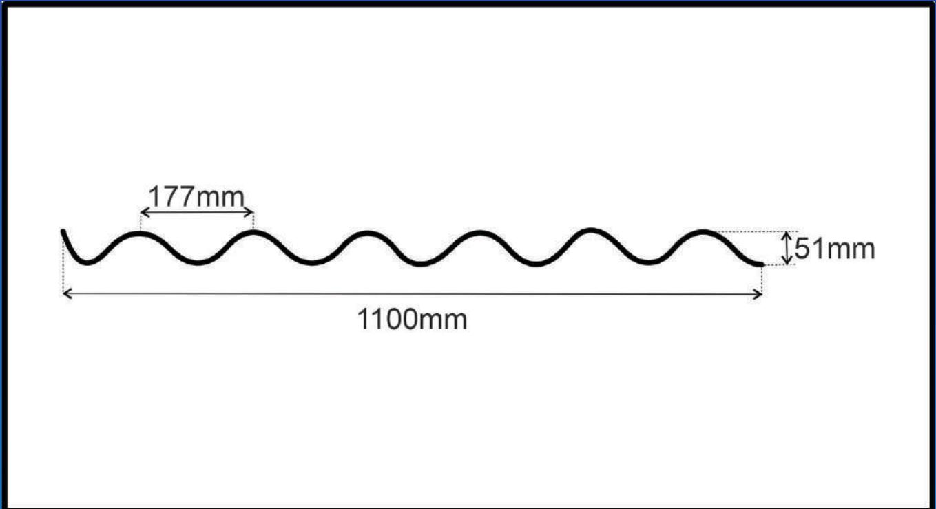
Perfil telha onda alta 0,92m:
